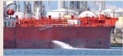
Nye balastsystemer. Bruk av ballastvann forbedrer skipets styrke, stabilitet og sjøegenskaper i ulastet tilstand, men øker brenselforbruket og utgjør en trussel for havets økologiske systemer.
