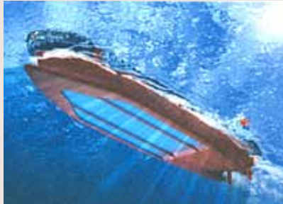
Optimaliserte skrogformer og radikalt nye konsepter med f.eks. hulrom i skrogets bunn, fylt med luft, reduserer friksjonsmotstanden mot vannet.
